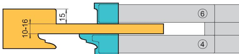
Úzké čepovací nože v horním nástroji jsou určené pro interiérové dveře.
