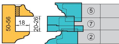
Také zde je použita úzká zasklívací lišta. Vložená fréza rozšiřuje drážku pro použití izolačního dvojskla nebo tepelně izolační výplně.
