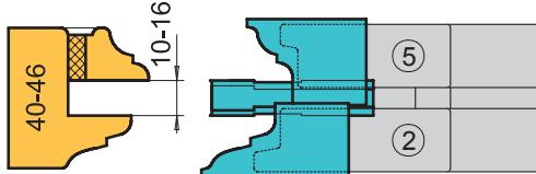
Úzká zasklívací lišta, respektující charakteristiku základního profilu
